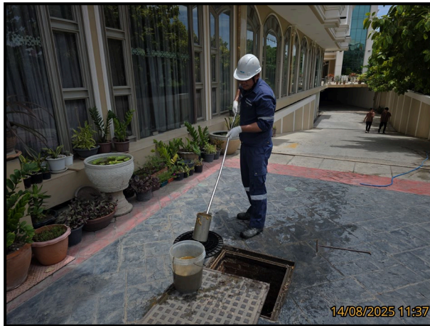
รูปที่ 3-1 การเก็บตัวอย่างน้ำเสียจุดที่ 1 บริเวณก่อนเข้าระบบบำบัดน้ำเสีย (อาคาร A)
