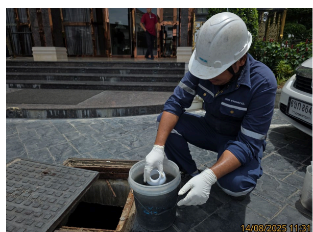
รูปที่ 3-3 การเก็บตัวอย่างน้ำทิ้งจุดที่ 5 บริเวณบ่อพักน้ำสุดท้ายของระบบบำบัดน้ำเสีย ก่อนระบายออกจากโครงการ
