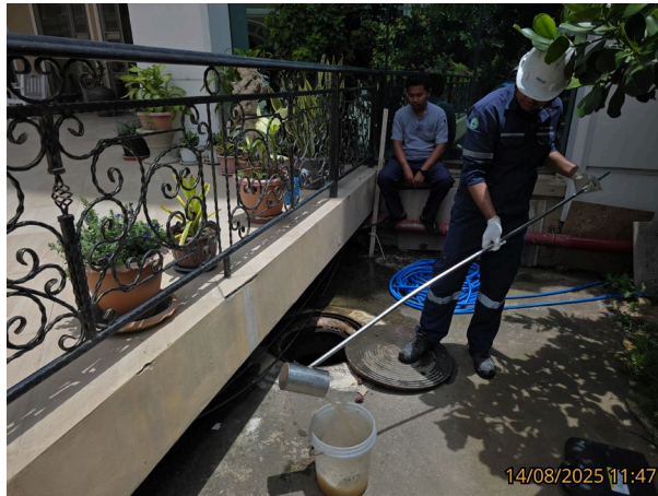
รูปที่ 3-2 การเก็บตัวอย่างน้ำทิ้งจุดที่ 2 บริเวณก่อนเข้าระบบบำบัดน้ำเสีย (อาคาร B)
