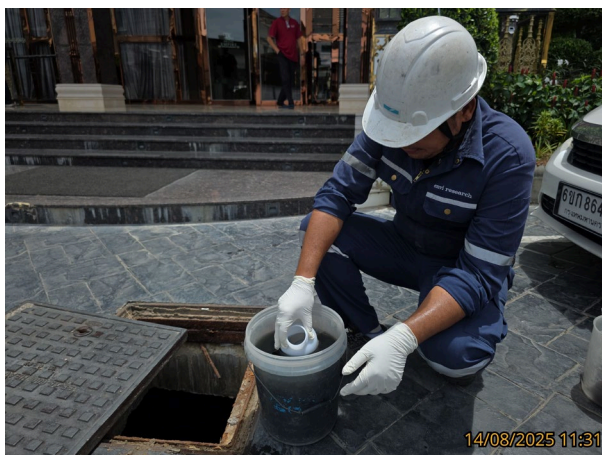
รูปที่ 3-3 การเก็บตัวอย่างน้ำทิ้งจุดที่ 5 บริเวณบ่อพักน้ำสุดท้ายของระบบบำบัดน้ำเสีย ก่อนระบายออกจากโครงการ
