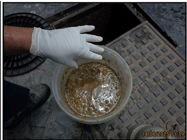
รูปที่ 3-1 การเก็บตัวอย่างน้ำเสียจุดที่ 1 บริเวณก่อนเข้าระบบบำบัดน้ำเสีย (อาคาร A)
