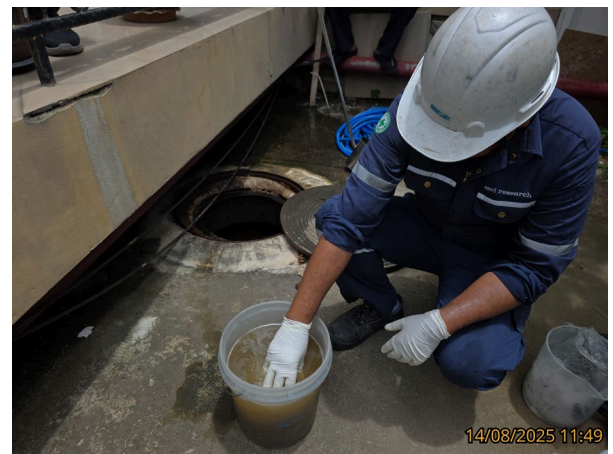
รูปที่ 3-2 การเก็บตัวอย่างน้ำทิ้งจุดที่ 2 บริเวณก่อนเข้าระบบบำบัดน้ำเสีย (อาคาร B)
